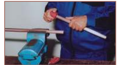
2. Külső-belső sorjátlanítás Munkaeszköz: külső-belső sorjátlanító
