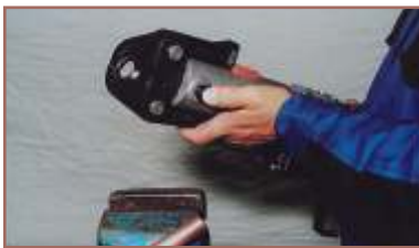
6. Megfelelő présprofát behelyezni a prés gépbe, csapszeget ütközésig benyomni
