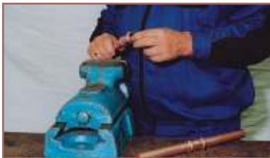
3. Tömítőelem meglétének, illetve helyes elhelyezésének ellenőrzése
