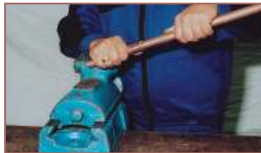
4. Rézcső és a présidom összenyomása ütközésig, könnyű csavarással
